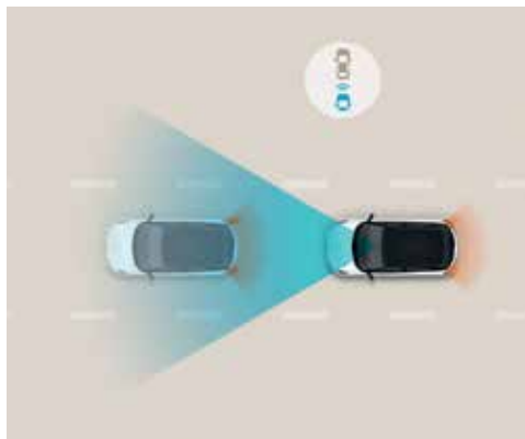
Sistem za preprečevanje naleta (FCA).
