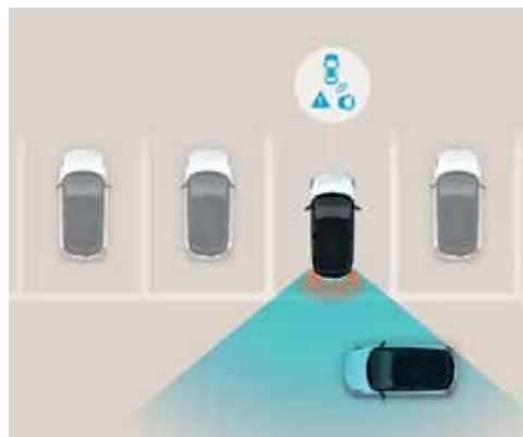
Sistem za preprečevanje naleta s strani pri vožnji vzvratno (RCCA).
