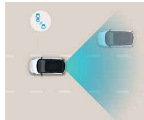
Sistem za zaznavanje mrtvih kotov s funkcijo preprečevanja trka (BCW).
