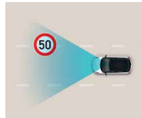
Inteligentni sistem za spremljanje hitrostnih omejitev (ISLA).
