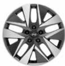
18-palčna alu platišča Okrasni pokrovček vključen, uporaba originalnih matic 7.5Jx18, 225/55 R18 AL400ADE08BC
